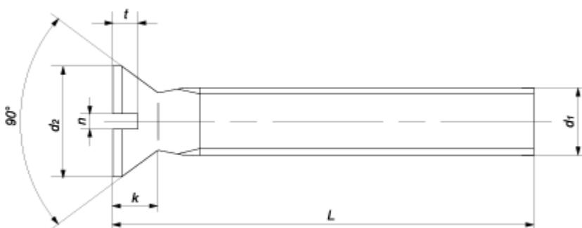
**Винт DIN 965, класс прочности 5.8** — оцинкованный винт с потайной головкой и крестообразным шлицем применяется в машиностроении, приборостроении, автомобилестроении, мебельной промышленности для соединения деталей машин и механизмов.
