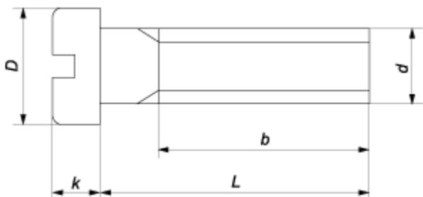
**Винт ГОСТ 1491-80, класс прочности 5.8** — винт с цилиндрической головкой с прямым шлицем.
