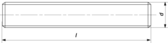
**Шпилька (штанга) резьбовая DIN 975**, класс прочности 8.8, оцинкованная с метрической резьбой по всей длине предназначена для наращивания крепежных конструкций с метрической резьбой, подвески воздуховодов, систем вентиляции на потолочных перекрытиях. Для удлинения конструкций на основе резьбовой шпильки используют соединительные гайки. Изготавливается длинами 1 и 2 метра.
