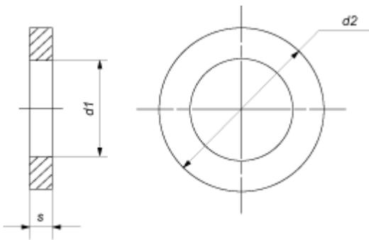
**Шайбы ГОСТ 52646-2006 к высокопрочным болтам** — вместе с высокопрочными болтами ГОСТ 52644-2006 и гайками ГОСТ 52645-2006 широко применяется в качестве детали соединения стальных строительных конструкций, в том числе мостовых, а также для металлических конструкций.
