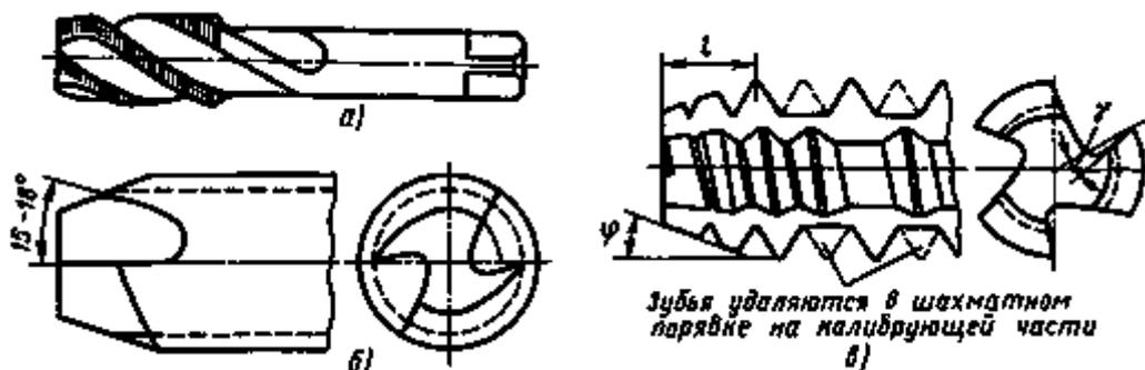
**ГОСТ 6227-80** — распространяется на метчики, предназначенные для нарезания конической дюймовой резьбы с углом профиля  $60^\circ$  по ГОСТ 6111 и трубной конической резьбы по ГОСТ 6211 на сверлильных станках, автоматах и агрегатных станках с применением специальных патронов для нарезания конической резьбы в резьбовых соединениях трубопроводов машин и станков. Изготавливаемые для нужд экономики страны и экспорта.
